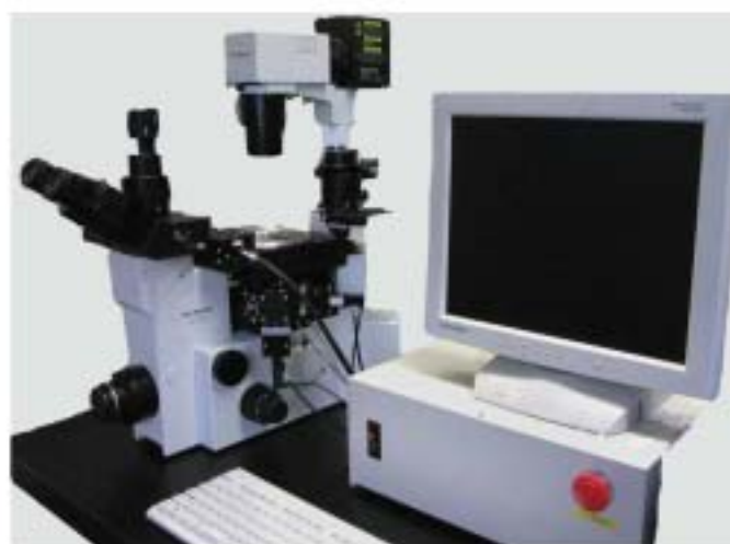
図2 アドオン型レーザーマニピュレータ（顕微鏡に取り付けたところ）
