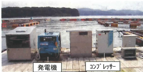
図8 開発した魚類養殖場用マイクロバブルシステム
