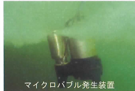
図8 開発した魚類養殖場用マイクロバブルシステム
