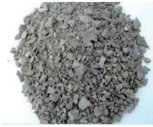
図1 試験材料に用いた人工リン鉱石
