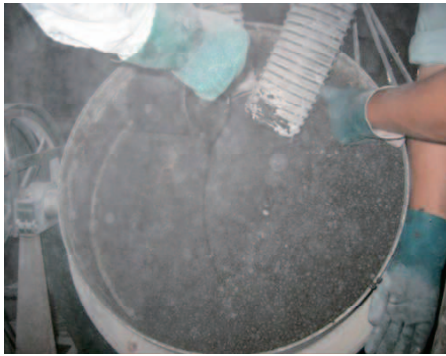
図3 人工リン鉱石を原料に用いた加工リン酸肥料の製造の様子
