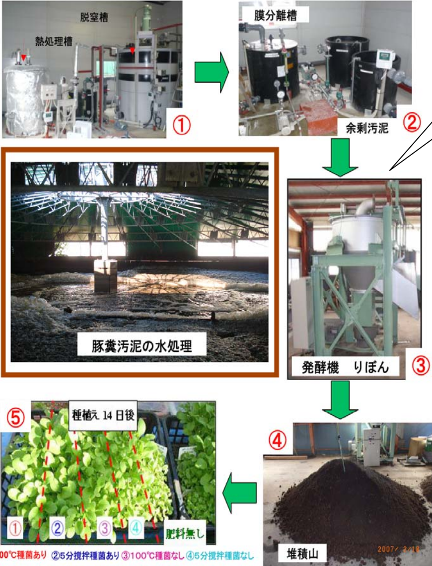
図4 ①②③④⑤構築した実験プラント 搾汁残渣と廃水処理汚泥の混合は、 N_2O 発生を防ぎ、堆肥化期間を2週間という短さに短縮した。
