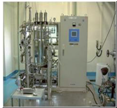
図3 BJ-AFP1生産のための培養装置: ジャーファーマーター(写真は90L容)
