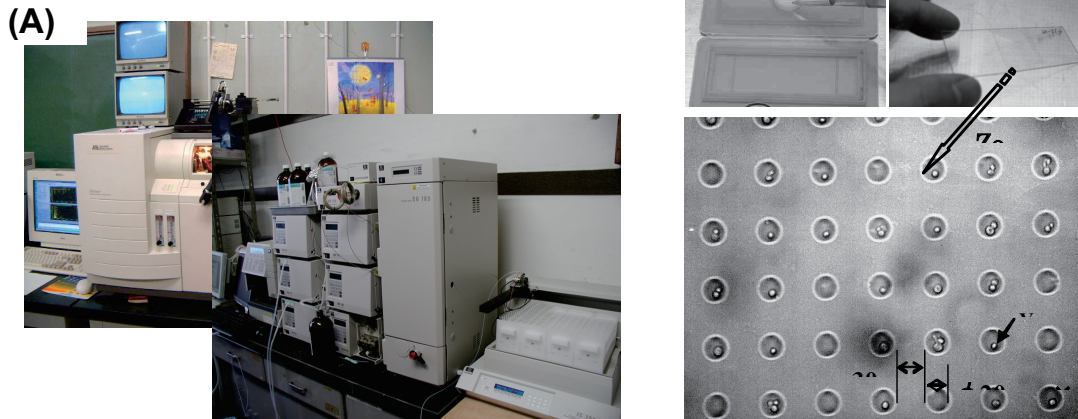
図 3 2次元マイクロキャピラリーカラムナノ HPLC と質量分析計の共役システム (A)、および細胞表面提示酵母マイクロチップシステム(B)
