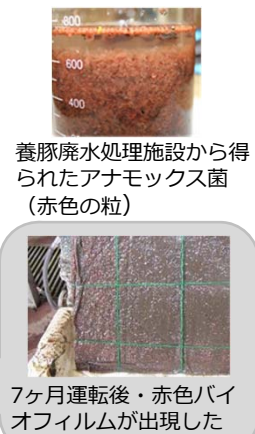
図2 ラボスケールのアナモックスリアクター
