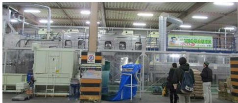
図3. JAなすのに設置した事前乾燥処理装置を組み込んだ温湯消毒システム
