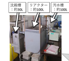
図3 自生施設的环境条件を再現したリアクター
