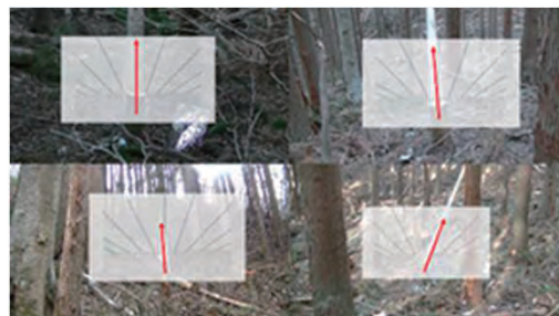
膨張剤を投入した 全ての試験木が±10度以内に倒木
