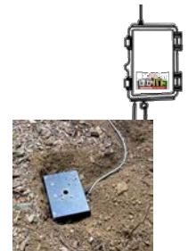
図2 くり罠のIoT遠隔ストッパー
