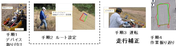
図1-2 走行方向補正システムを利用した作業の流れの操作手順 運転中はウィンカーによる方向指示で走行方向を自動的に補正 作業終了後は、作業時間や作業の正確性の確認が可能
