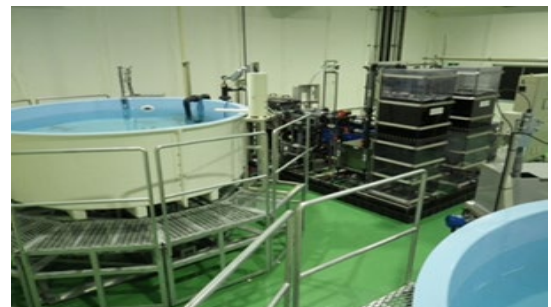
図2. 閉鎖循環式陸上養殖システム
