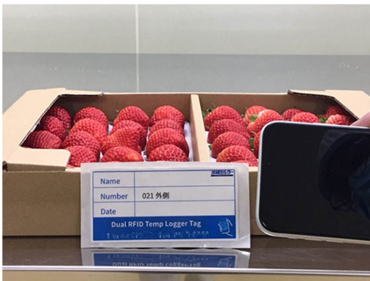
図2 RFID 温度ロガータグ
