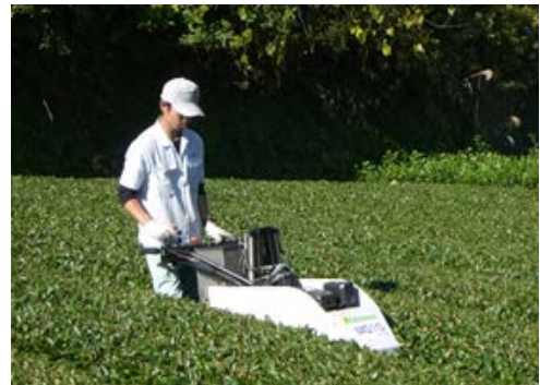
写真1 茶園局所施肥機 茶樹の樹冠下の土壌に緩効性肥料を打ち込み施肥作業回数を削減
