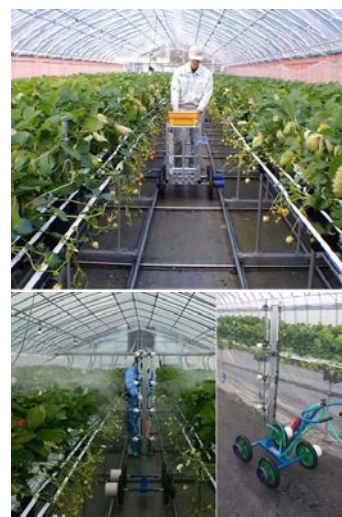
図3 試作した収穫台車(上)及び防除機(下)
