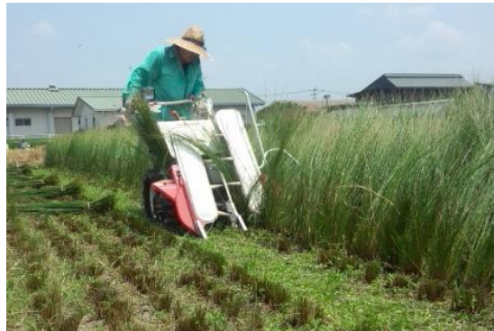
図3. 米麦用バインダーによる最終収穫
