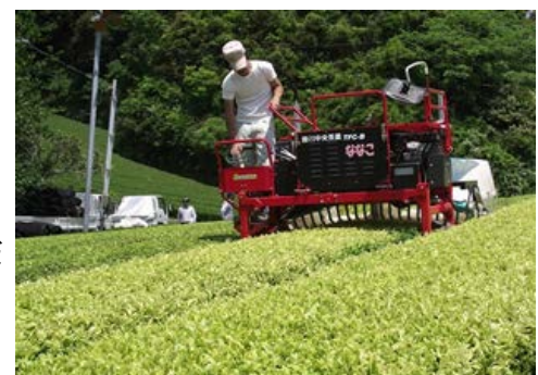
写真1 茶園局所施肥機 茶樹の樹冠下の土壌に緩効性肥料を打ち込み施肥作業回数を削減
