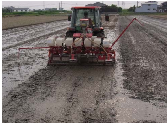
写真2 ショットガン直播機による湛水直播
