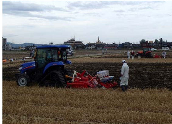
写真2 耕うん同時畝立て播種による大豆播種 ※写真1の水稲播種と同じトラクタを使用
