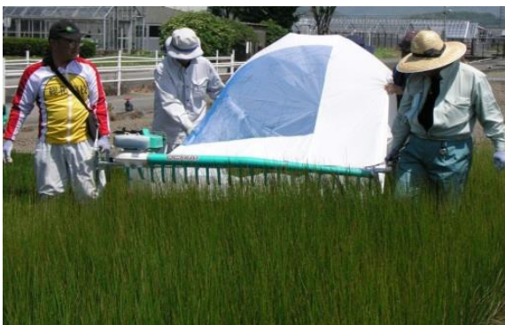
図2. 可搬式茶摘採機による中間収穫
