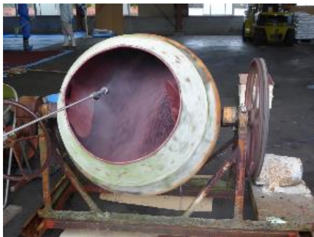
写真2 コンクリートミキサーでの被覆
