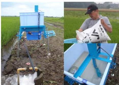
図1 開発した流し込み施肥装置
