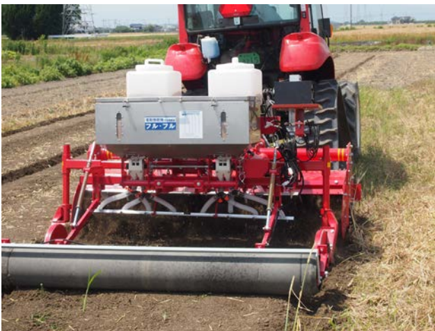
写真1 表層散播一工程播種 ※水稲乾田直播、麦類の播種が可能
