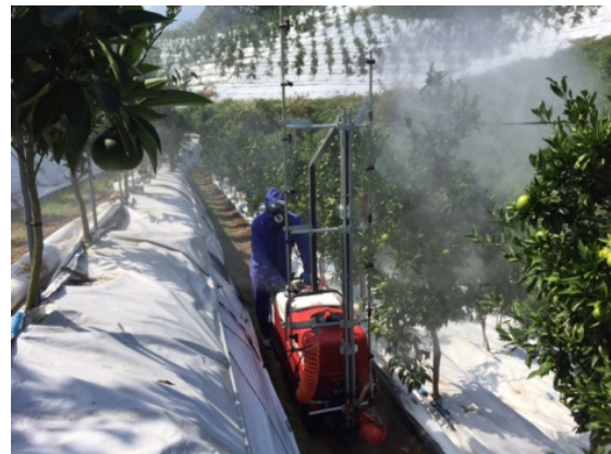
写真1 クローラ型防除機で防除
