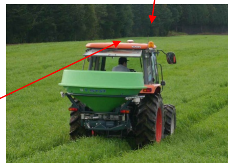
図3 マップの数値に従い、ポイントごとに施肥量を変えながら散布
