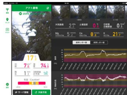
写真2 栽培計測データ視覚化アプリのモバイルタブレット画面例（栽培環境の見える化）
