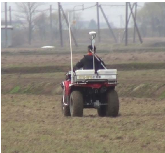
写真 1 GNSS バギー車による計測作業の様子
