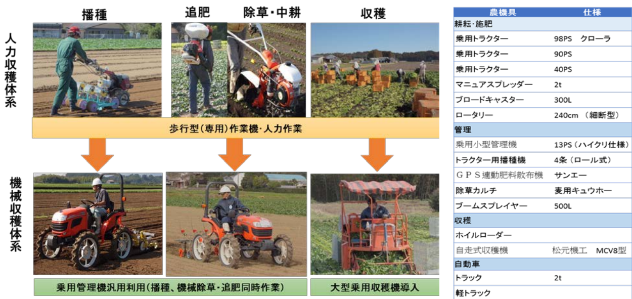
図1 大型乗用収穫機を中核とした加工用ハウレンソウ機械収穫体系
