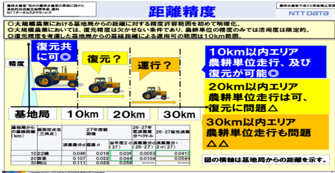
図 2 基地局からの距離が精度に及ぼす影響
