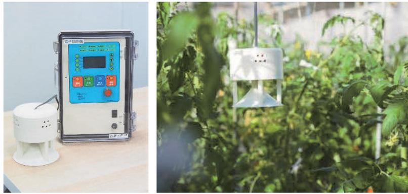
図2 園芸施設用コナジラミ類音響防除装置
