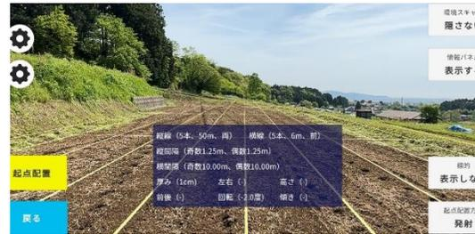
畝立てなどに必要な平行直線ガイドを圃場に表示する。ガイドはGNSS-RTKと連携させることで、誤差数cmの固定精度を実現。
