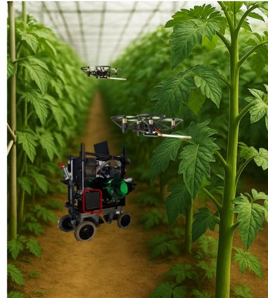
自動受粉・害虫防除のドローン・ロボットの実施イメージ。本プロジェクトでは振動と気流による自動受粉技術及び帯電水滴と空気砲による害虫防除技術を開発し、ドローン・ロボットに搭載する。それらをデジタルツインにより遠隔制御することを目指す。
