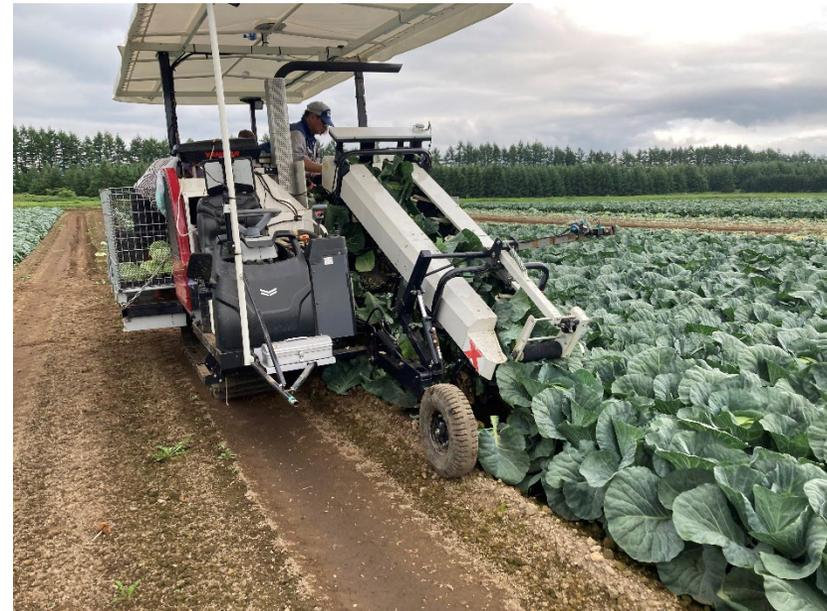
※自動操舵システムと掻き込み部の自動高さ調整が可能なキャベツ収穫機
