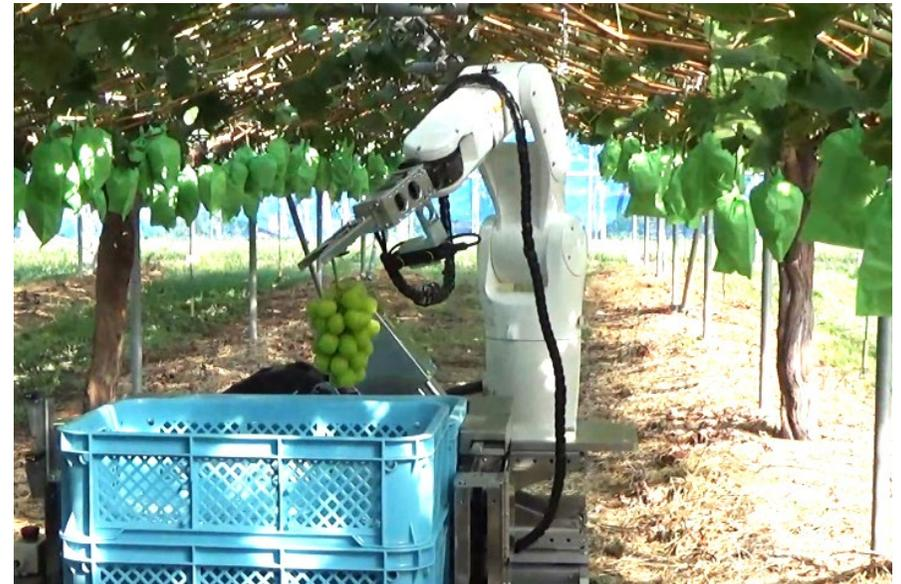
※ブドウ作業支援ロボットによる収穫の様子
