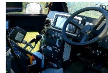
HST(無段変速機)レバー、噴霧バルブ、ハンドル、ブレーキ等を後付け装置で制御
