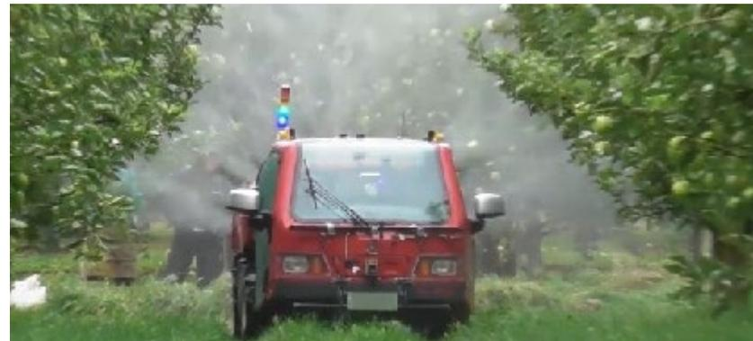
高精度衛星測位を用いて、あらかじめ手動走行して記憶した経路を自動運転で再現走行。曲線走行を含む複雑な経路や噴霧方向、噴霧停止等も再現
