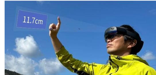
作物などのサイズを簡単に計測・データ保存できる機能。指先を用いた方式など、4種類の計測方式を利用できる。
