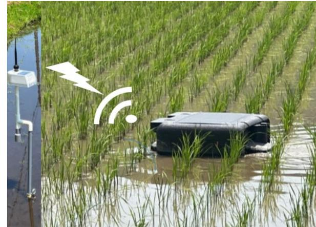
十分な水位となるように自動抑草ロボットから水位を調整するよう水管理システムへ指示を送る
