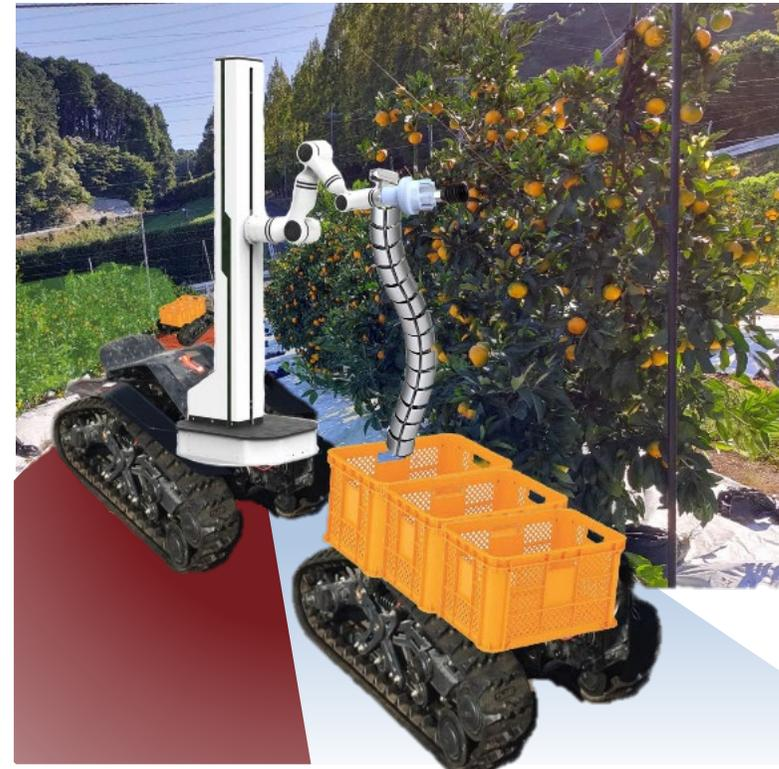
※双幹苗木によるロボット収穫用園地と自動収穫ロボット
