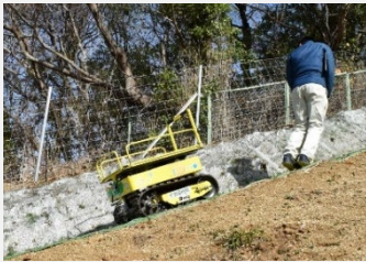
▲傾斜地でも登坂可能であることを特徴とするブドウ用小型電動ロボットのベースユニット
