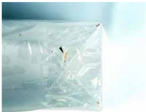
オーバーラップ包装のシール不良部から、侵入しようとするノシメダラメイガ幼虫
