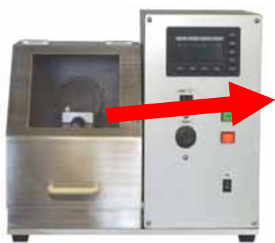
穀粒の切断・研磨装置(左)と切断部の拡大図(右) (Grain Cutter NFC02、千穂田精衡)
