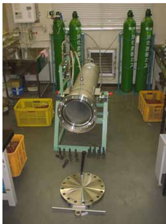
クリシギゾウムシ防除用 大型高圧二酸化炭素処理装置 サイズ: 直径40 cm , 長さ1.55 m 処理量: 70kg / 回
