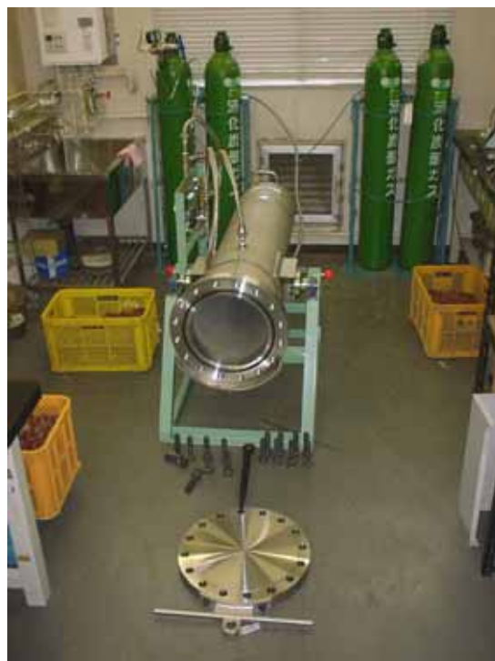
クリシギゾウムシ防除用 大型高圧二酸化炭素処理装置 サイズ: 直径40 cm, 長さ155 cm 処理量: 70kg / 回
