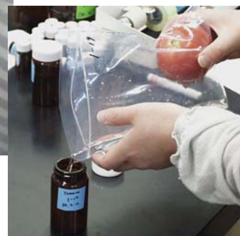
洗浄液の試料ビンへの回収
