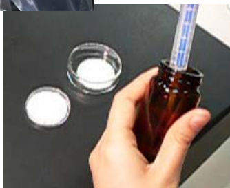
洗浄液のガラス製ろ紙による濃縮
