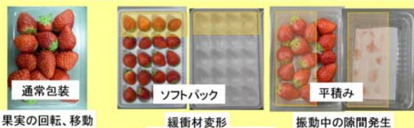
図4. 顕著な損傷例
