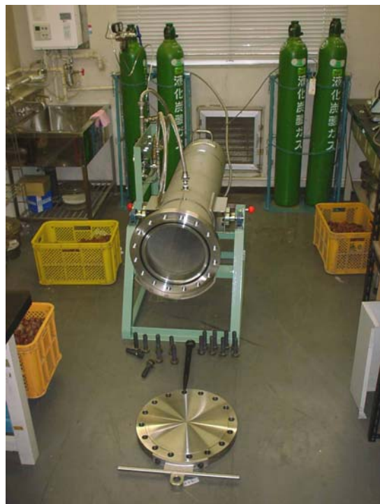
クリシギゾウムシ殺虫用の 大型高圧炭酸ガス処理装置 サイズ: 直径40 cm, 長さ155 cm 処理量: 70kg / 回
