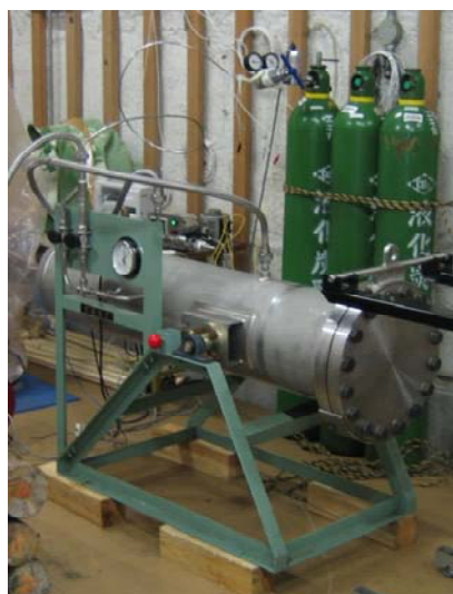
クリシギゾウムシ殺虫用の 幼虫(上)と被害クリ(下) 大型高圧炭酸ガス処理装置 サイズ: 外径40 cm, 長さ: 155 cm 処理量: 70kg / 回
