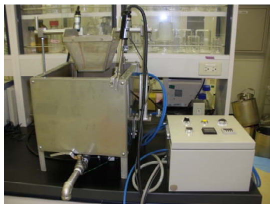
図1 種子の熱水殺菌装置
