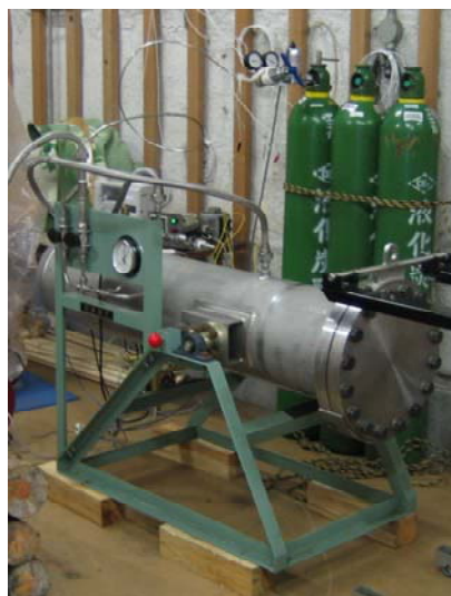
クリシギゾウムシ殺虫用の 高圧炭酸ガス処理 サイズ: 外 0 , 長さ: 155 処理量: 70 回
