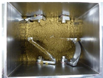
攪拌・混合処理
