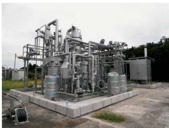
図2 実証プラント(設計製造能力:400 L/d(146 KL/y))
