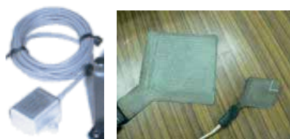
図3. 実験に用いたセンサ (左: 加速度センサ、右: 多点圧力センサ)
