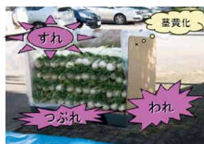
図1. 新規バルクコンテナによるダイコンの測定に用いたセンサ輸送実験風景
