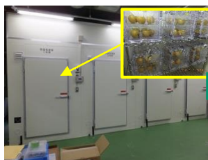
恒温、恒ガスコントロール試験室
