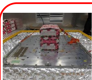
鷺宮製作所製 3次元振動試験機
