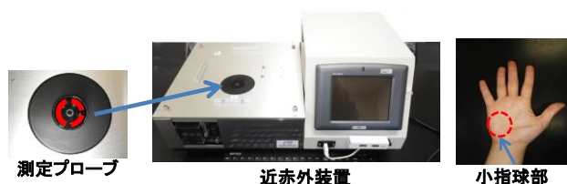
図1: 非侵襲血糖値測定用近赤外分光装置およびスペクトル測定部位
