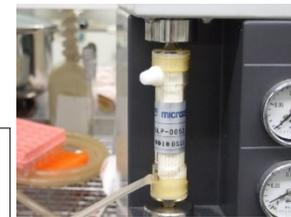
中空糸UF膜による酵素除去
