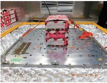
図1 3次元振動試験機による振動試験風景
