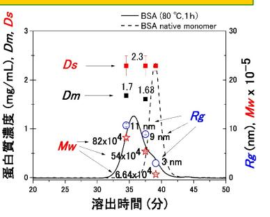
散乱データの解析により、分離溶出分子の回転半径(Rg)、分子量(Mw)およびフラクタル次元(質量および表面; Dm&Ds)などの溶存高分子の構造特性指標が計算でき、生体高分子含有食品の加工適正や成分評価が可能です。
