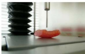
赤道部の切片を直径9 mmの穴開き試料台に設置（外果皮を下側）
