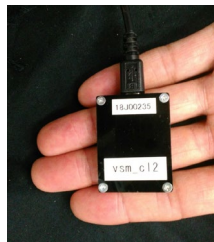
採用した可視・近赤外分光センサ (C14384MA-01, 浜松フォトニクス)
