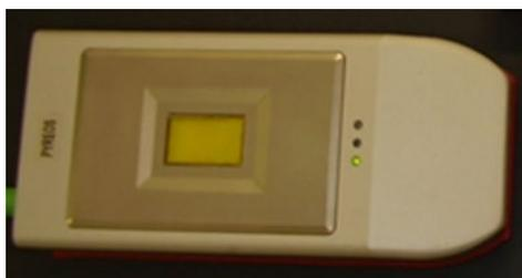
醤油をプリズム（黄色の部分）に滴下して測定するだけ
