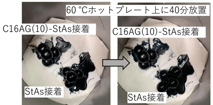
ガラス玉を骨材に見立てアスファルトで接着し、60℃で放置。C16AGを含むアスファルトで接着したガラス玉は崩れず形態を保つ。
