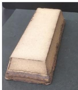
左図 稲わら粉末をGrAASプロセスにより処理して試作した糖備蓄のための「糖の延べ棒\*\*」
