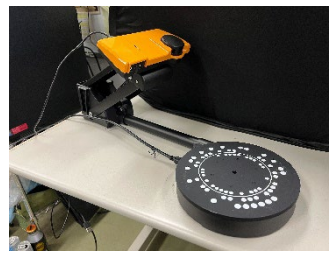
3Dスキャナを用いたデータ取得 (解像度0.1 mm)
