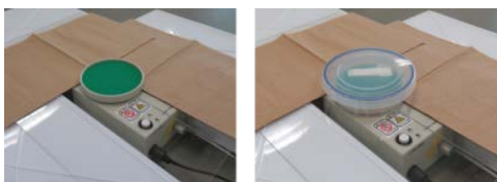
図 18 ターンテーブルへの薬液飛散対策
