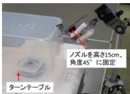
図 19 虫体・葉片散布法で使用する薬液散布システム
