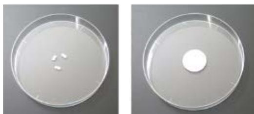
図 20 薬液散布量の測定に使用するシャーレ
