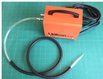
図7 吸虫管と吸引ポンプの接続
