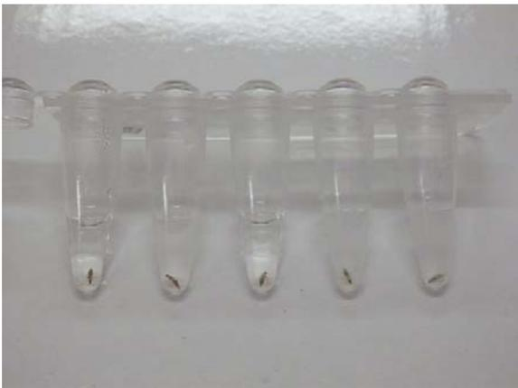
PCR チューブの抽出バッファに浸したネギアザミウマ成虫
