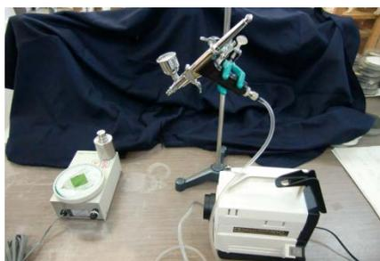
図 7 簡易散布装置
