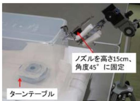
図 19 虫体・葉片散布法で使用する薬液散布システム
