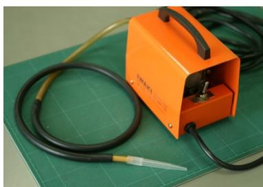
図10 吸虫管と小型吸引ポンプ
