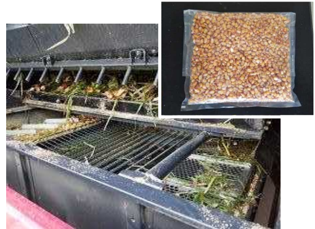
収穫中に脱穀選別部の中を確認したところ、特に異常は確認されなかった
