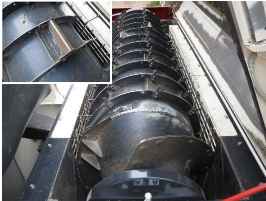
スクリー方式の脱穀部 左上写真は、スクリーロータに設置されている拡散板
