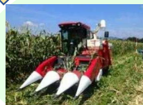
国産コーンヘッダ（汎用コンバイン用トウモロコシ専用収穫ヘッダ）が市販開始(R2年)
