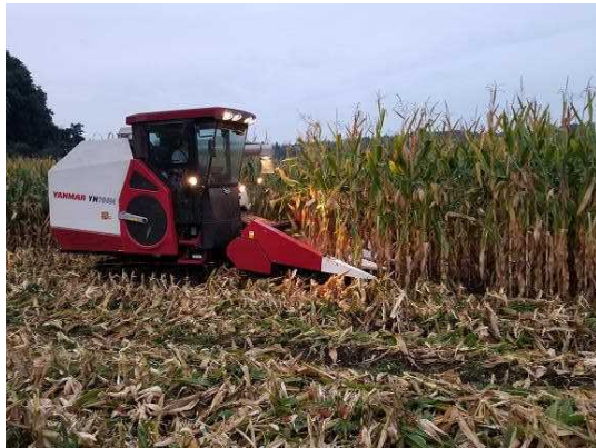
中型汎用コンバイン（YH700M）で早生品種（P1184）を小雨条件の中で収穫する様子（子実水分28.1%）
