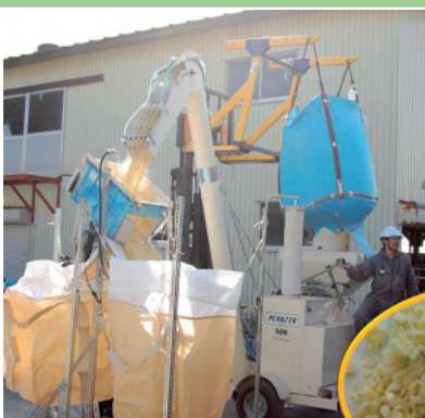
< 破碎・加水（乳酸菌添加） or 無破碎 ・ 内袋なしのフレコンへの詰め込み >
