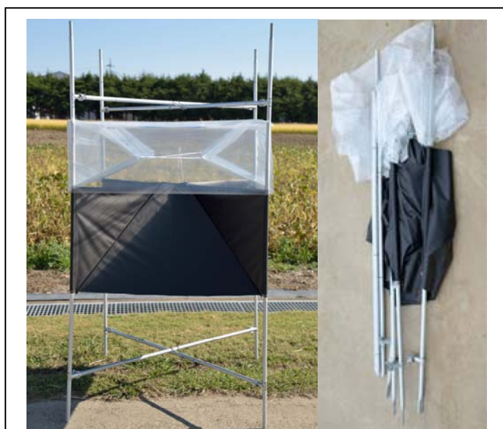
図 1 新型トラップ 左：設置状態 右：折り畳んだ状態
