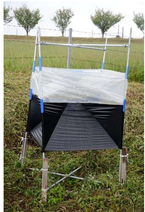
写真 2 歪んで設置されたトラップ
