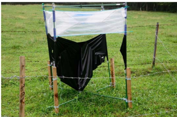
写真 1 シカによって破損したトラップ
