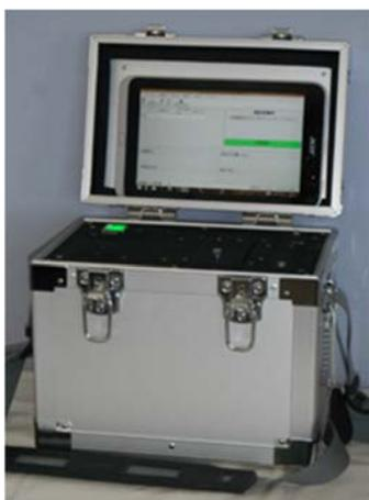
図 携帯型血液成分測定装置
