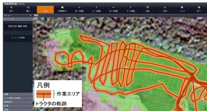
図 7 トラクタの走行軌跡と作業範囲の表示例
