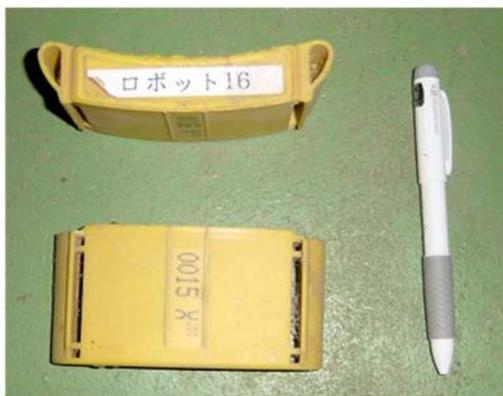
a) 搾乳牛用パッシブ型無線ICタグ
