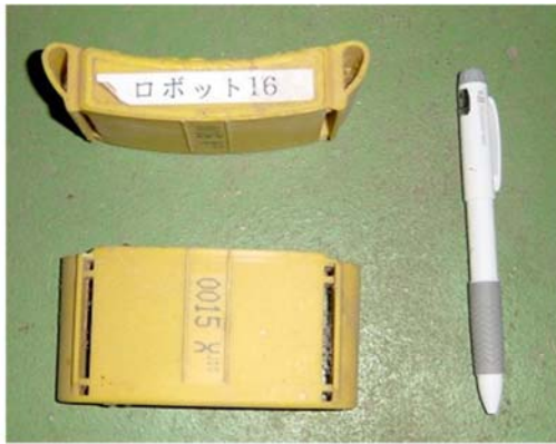
a) 搾乳牛用パッシブ型無線ICタグ
