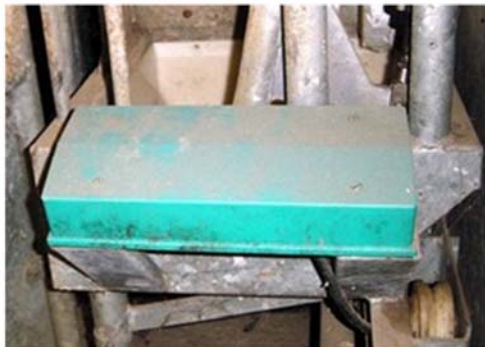
c) 無線ICタグの読み取りアンテナ (搾乳ロボット搾乳室)
