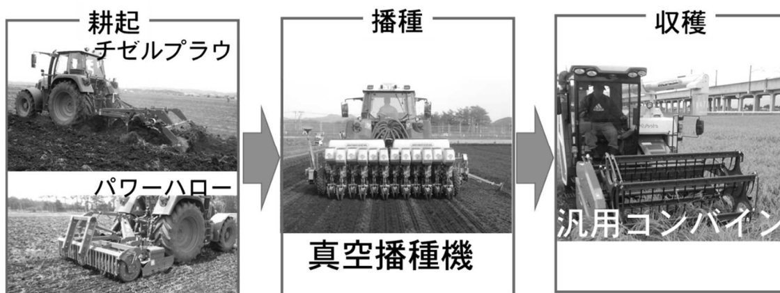
図3 子実用トウモロコシを導入したプラウ耕水田輪作の機械体系
