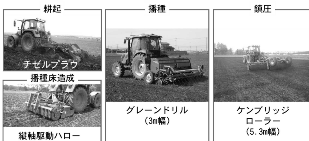
図1 プラウ耕鎮圧体系乾田直播の機械体系
